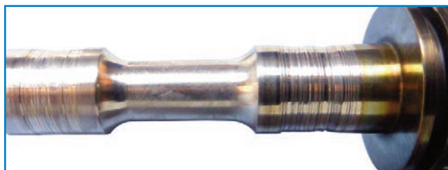
Marcatore sul diametro della boccola della Girante Turbina
